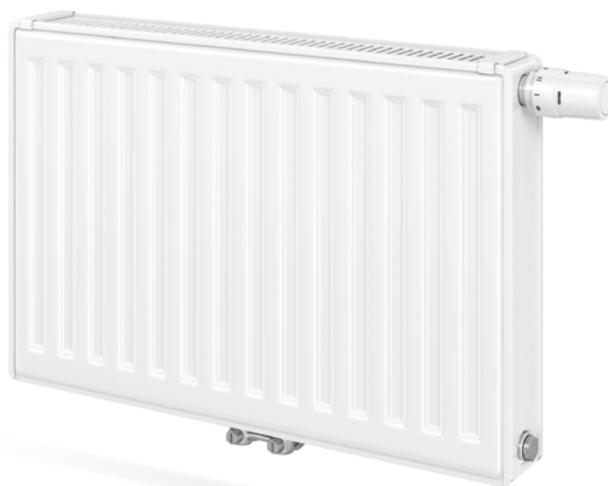
Le **T6 3010**, radiateur panneau à **raccordement central**, est délivré avec un **insert thermostatique universel M30x1,5 pré-monté en usine** pour plus de flexibilité dans le choix de votre tête thermostatique. Les nombreux avantages tels que la pression de service de 10 bar, la canne intégrée en forme de T, la finition aux bords arrondies ainsi que les joues latérales et la grille supérieure sont conservées.
