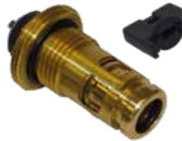
Denn hier muss lediglich die erforderliche Wassermenge unter Berücksichtigung der Heizkörperleistung und der Systemtemperaturen eingestellt werden. Der Ventileinsatz sorgt für einen konstanten Volumenstrom. Die Einstellung erfolgt einmalig und wird mit dem im Lieferumfang enthaltenen Skalenschlüssel vorgenommen. Durch die Skalierung in l/h ist die Einstellung schnell und unkompliziert. Voraussetzung für den Einsatz des dynamischen Ventils ist allerdings ein verschmutzungsfreies Anlagenwasser.
