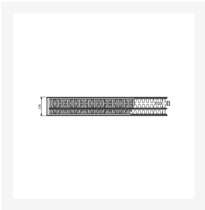
DimensionalDrawing - Plint PD og Plint RD, type 33, set oppefra
