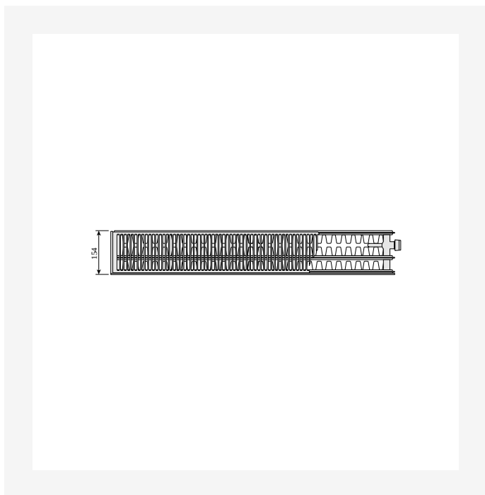
DimensionalDrawing - Plint P og Plint R, type 33, set oppefra
