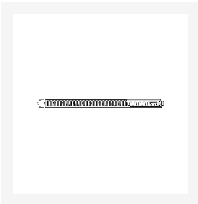
DimensionalDrawing - Plan Ventil Compact og Ramo Ventil Compact, type 21s, højre, set oppefra
