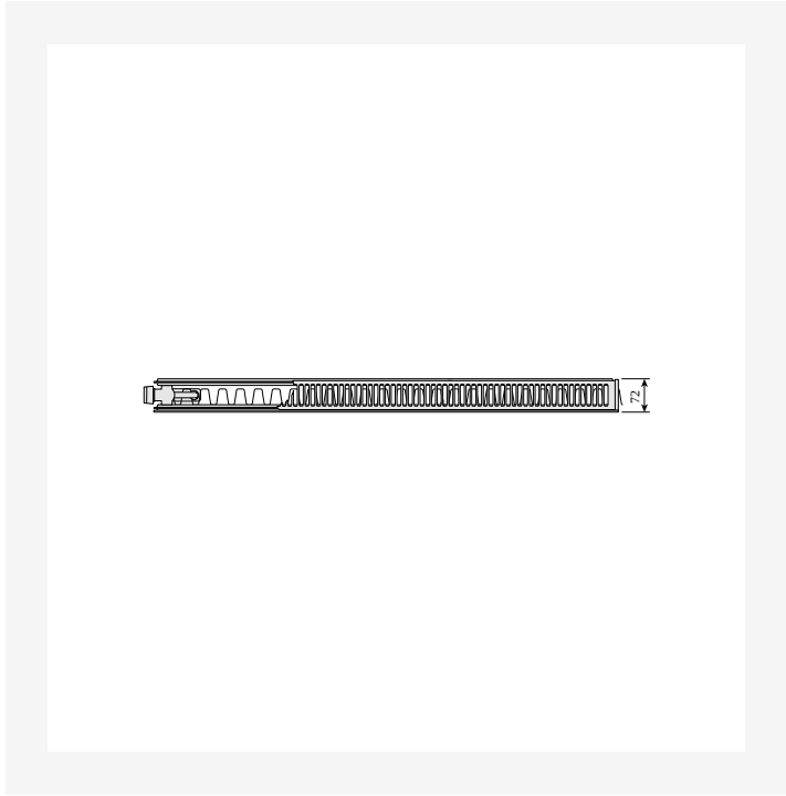
Schiță dimensională - Plan Ventil Compact și Ramo Ventil Compact, tip 21s stânga, vedere de sus
