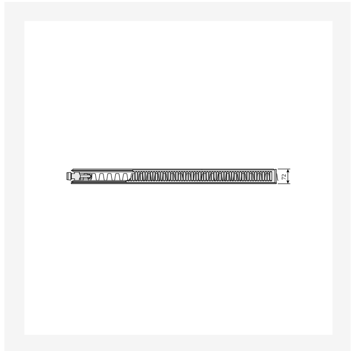
Dimensional Drawing - Plan Ventil Compact și Ramo Ventil Compact, tip 21s stânga, vedere de sus
