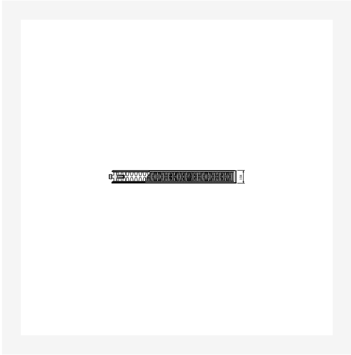
Dimensional Drawing - Plan Ventil Compact și Ramo Ventil Compact, tip 22 stânga, vedere de sus
