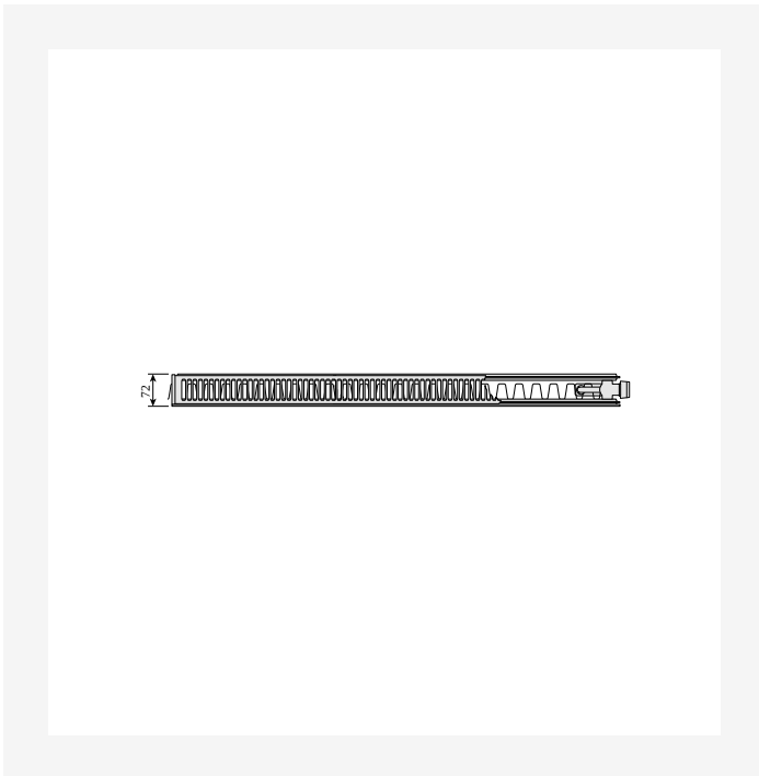
DimensionalDrawing - Plan Ventil Compact ja Ramo Ventil Compact, tyyppi 21s, oikea, ylhäältäpäin
