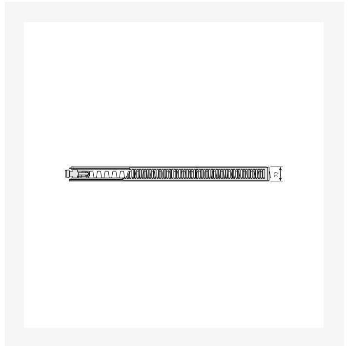
DimensionalDrawing - Plan Ventil Compact ja Ramo Ventil Compact, tyyppi 21s, vasen, ylhäältäpäin
