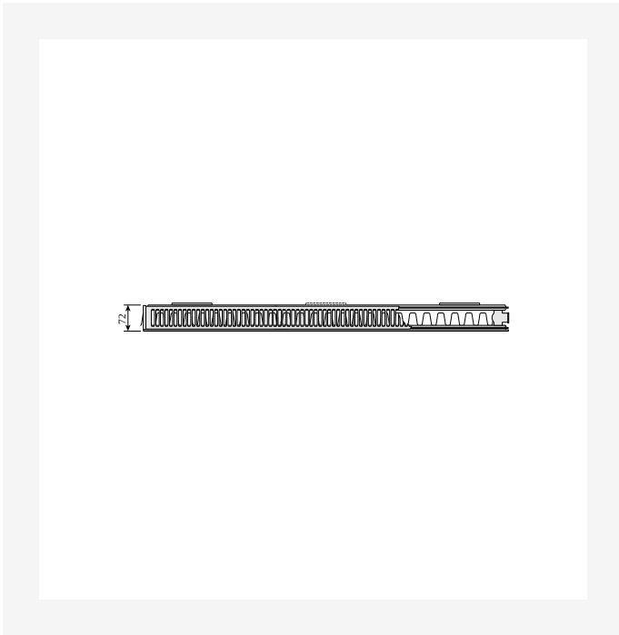
DimensionalDrawing - Plan Compact / Ramo Compact, tyyppi 21s, ylhäältäpäin
