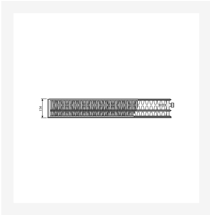
DimensionalDrawing - Plint P ja Plint R, tüüp 33, pealtvaade
