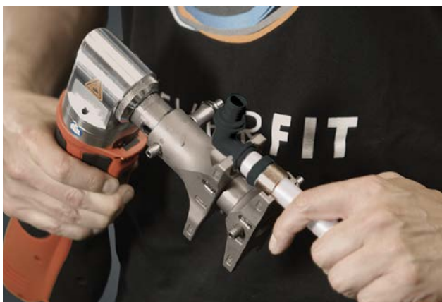
Tragerea inelului peste fitting
