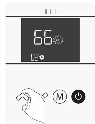
3- Bestätigen Sie, indem Sie einige Sekunden warten oder die (M) Taste drücken. Der Regler kehrt zur DEG Parametereinstellung zurück.
