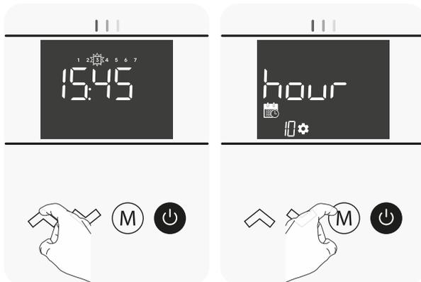
Bei einem Stromausfall von mehr als mindestens 2 Stunden gehen die Uhrzeit- und Tageseinstellungen verloren und müssen zurückgesetzt werden. Sie können Uhrzeit und Tag zurücksetzen, indem Sie die oben gezeigten Schritte wiederholen.
