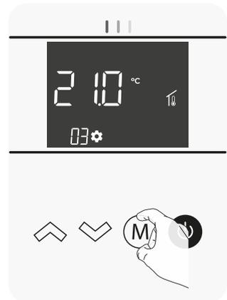
2- Erhöhen Sie die vom Umgebungstemperaturfühler gemessene Temperatur um 2°C, indem Sie auf (U) drücken. In unserem Beispiel geht die gemessene Temperatur des Fühlers von 21°C auf 23°C.
